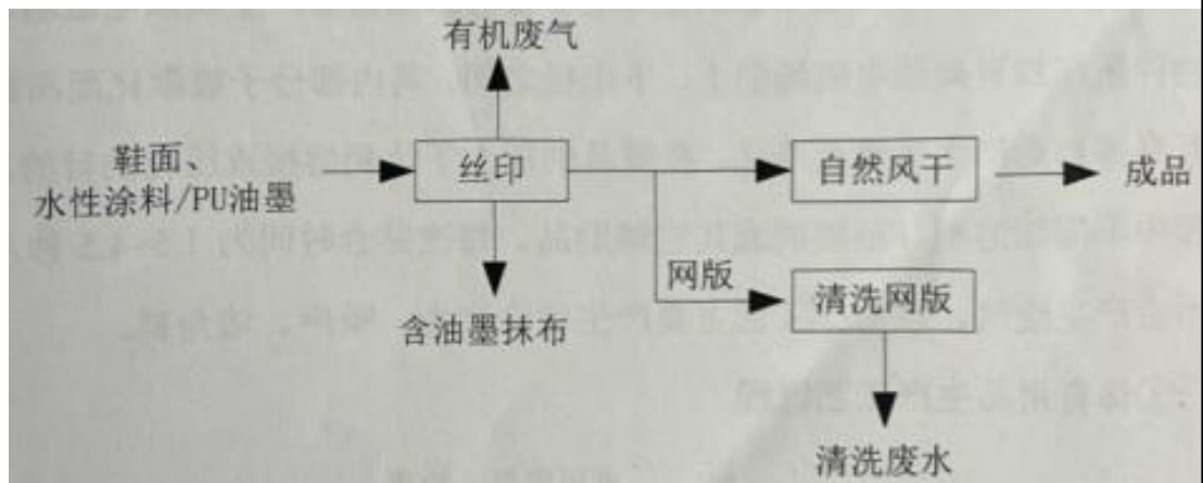
图 2-11 原项目汽鞋面（印刷）生产工艺流程及产污环节
