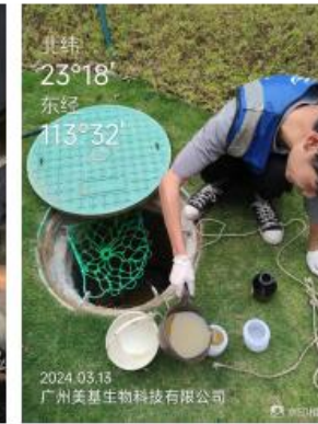
综合废水处理采样口 W3
